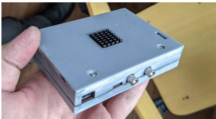
Рис. 6: Экранирующий корпус STM-VMM
