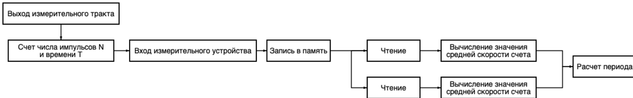
Рисунок 5 – Принципиальная схема алгоритма измерения периода
