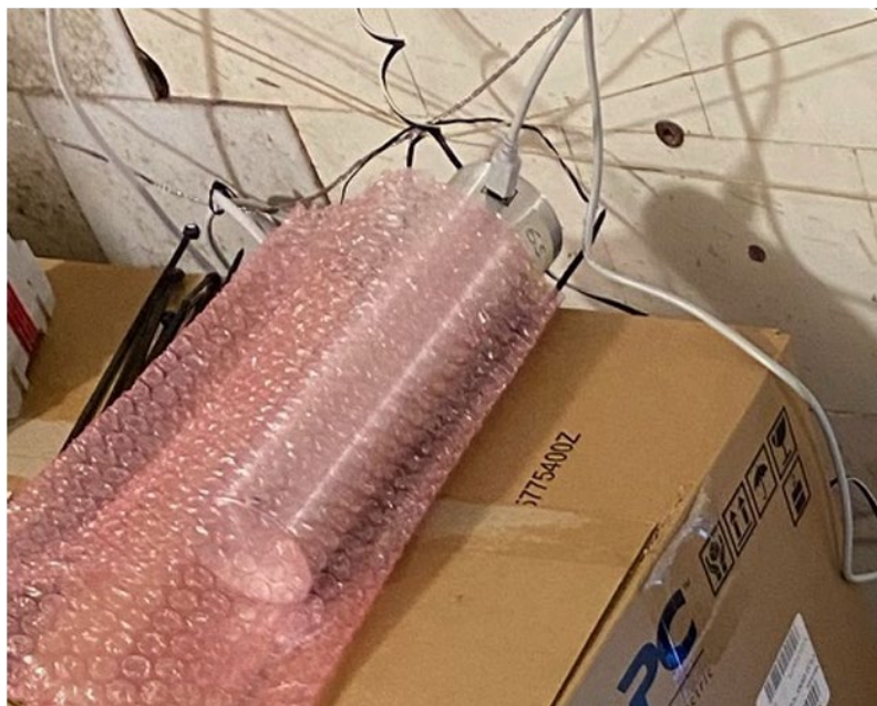
Рис. 2а,б – Фото реальной установки, а – ФЭУ и сцинтиллятор, б – детектор с изучаемыми образцами внутри свинцового короба
