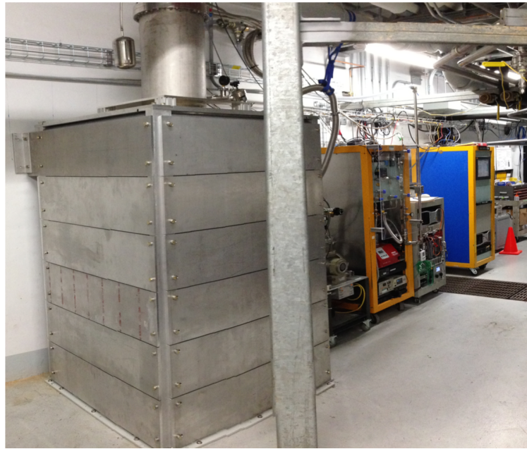
Рис. 3.5 – Детектор CENNS-10 в пассивной защите.
