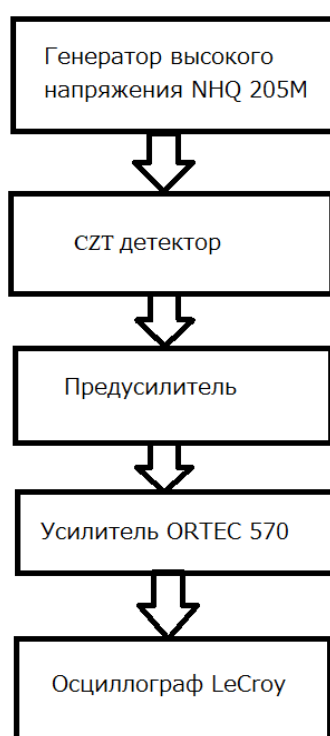
Рисунок 3.2 — Схема установки CZT-детектора.
