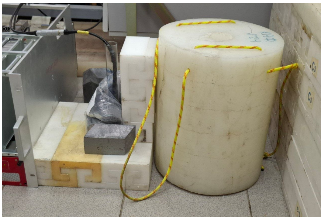
Рисунок 3.7 — Экспериментальная установка с CZT-детектором и нейтронной защитой.
