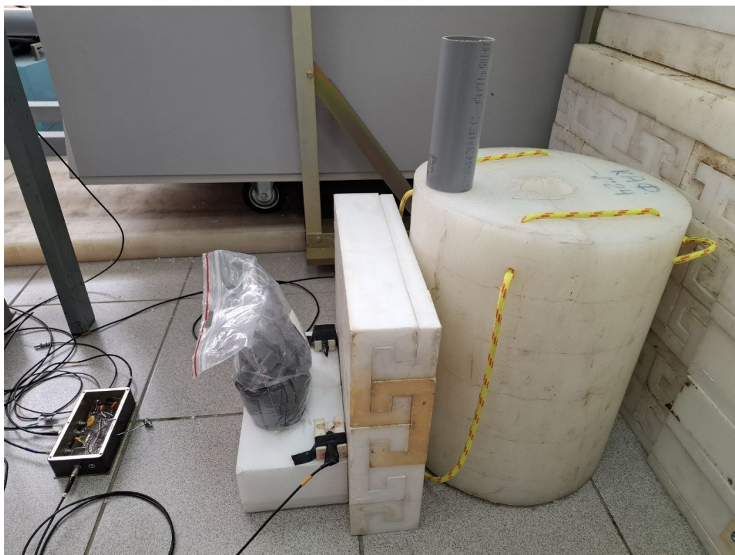
Рисунок 5.2 — Установка на основе сцинтилляционных детекторов.
