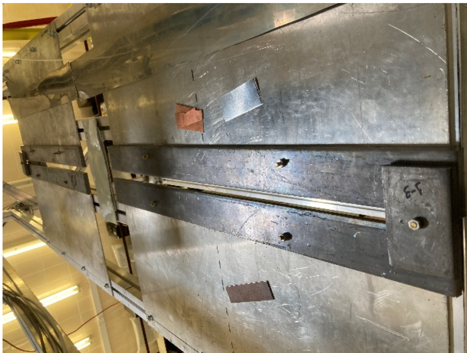
Рисунок 11 – Фотография вторичного коллиматора с регулируемой щелью
