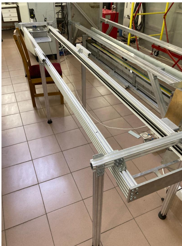
Рисунок 29 – Фотография калибратора-тележки на экспериментальном стенде
