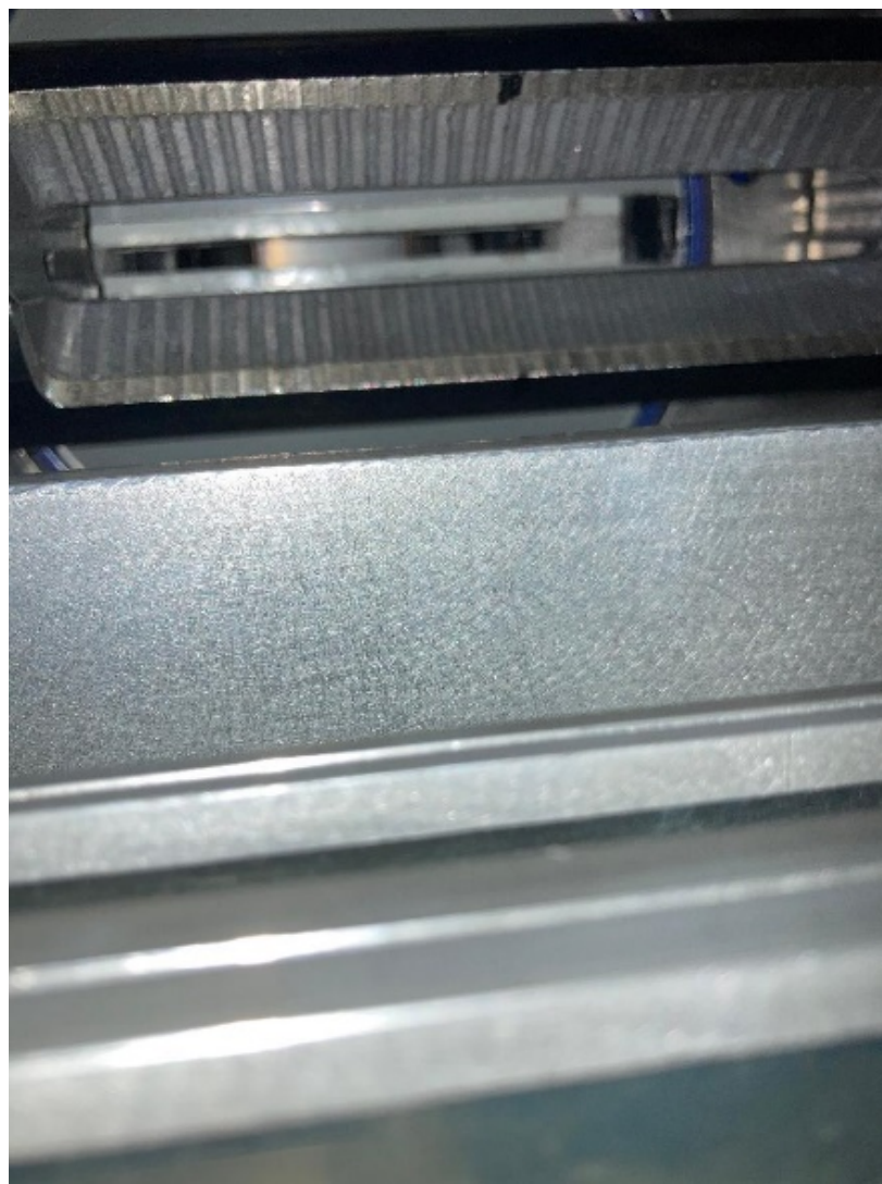
Рисунок 13 – Щель регулируемого коллиматора
