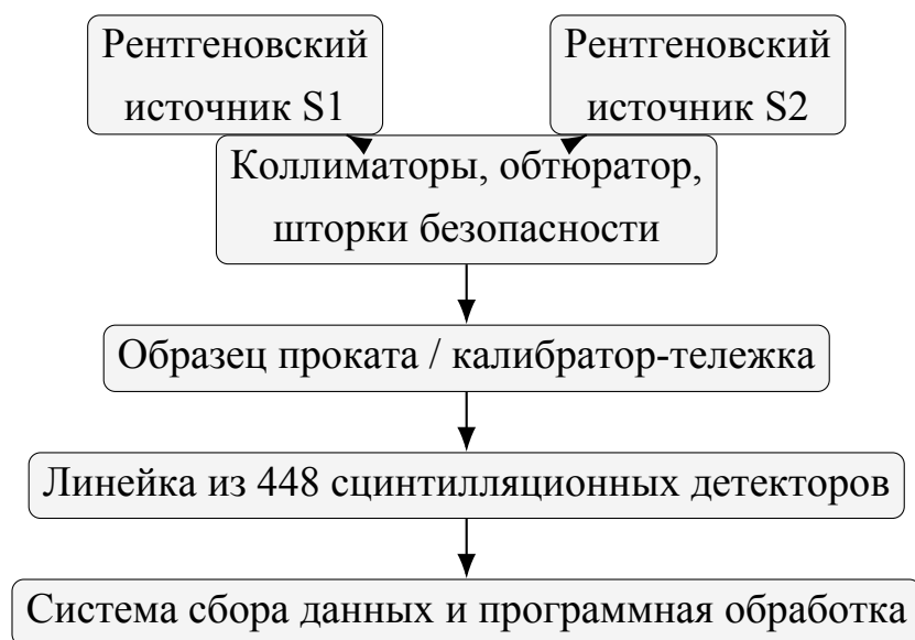
Рисунок 4 – Функциональная схема экспериментального стенда профилемера горячего проката
