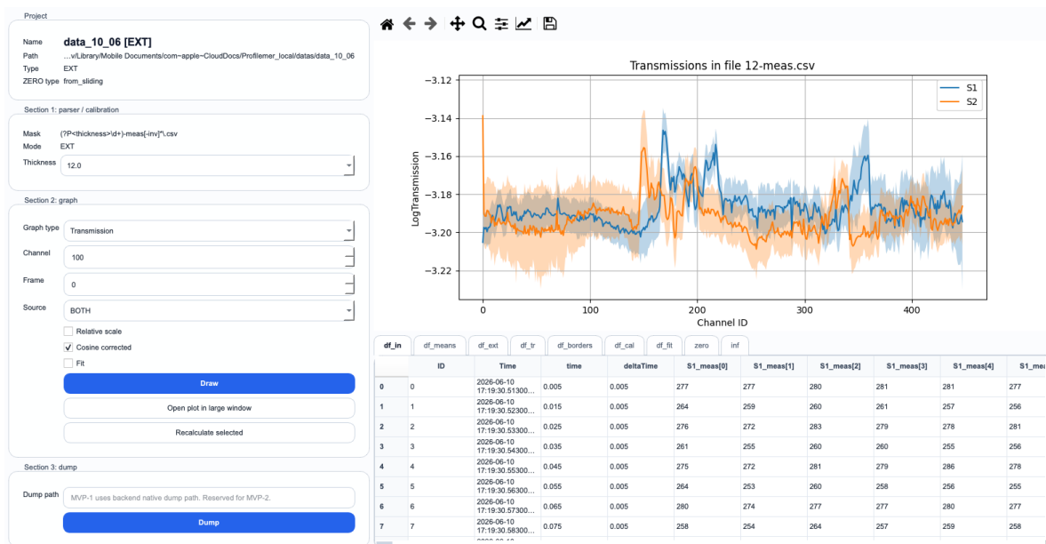
Рисунок 60 – Вкладка проекта с панелью параметров построения графика и встроенным Matplotlib-холстом
