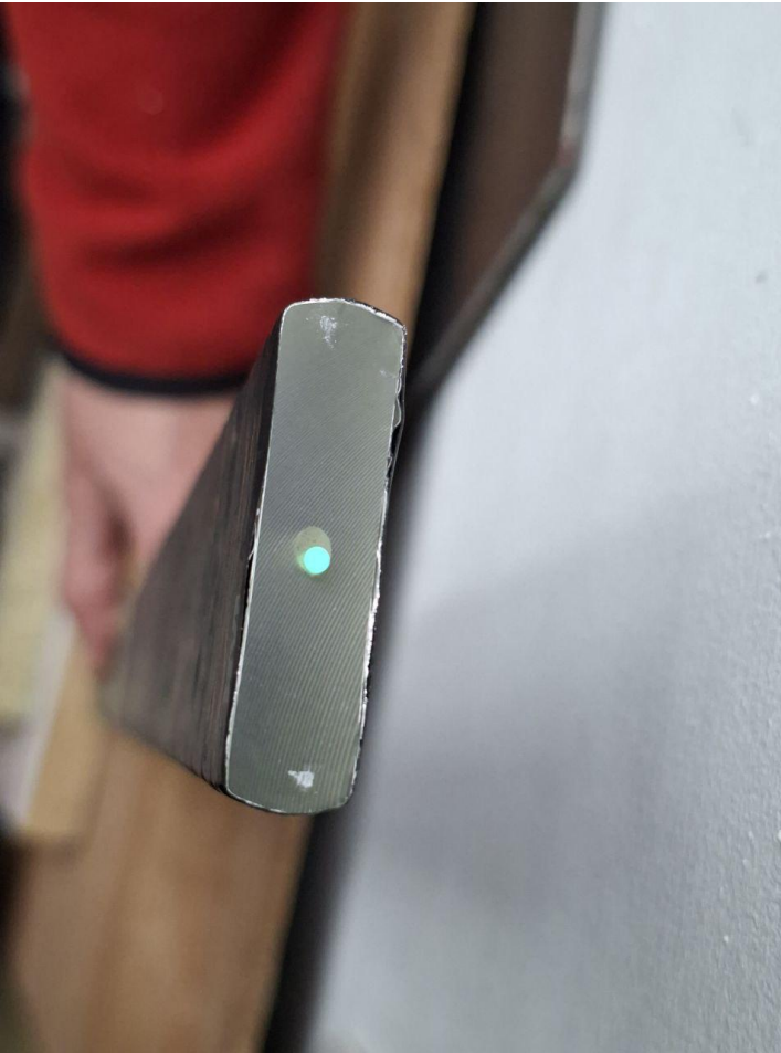
Китайский полистирол (покрашен белой краской, обмотан фольгой и изолентой)
