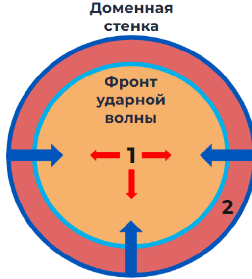
Рисунок 2.4 — Индекс 2 означает слой газа между стенкой и фронтом ударной волны, индекс 1 означает слой газа перед фронтом ударной волны (ядро)
