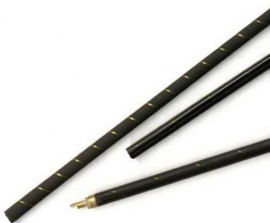
Рисунок 2 – Внешний вид газовых дрейфовых трубок
