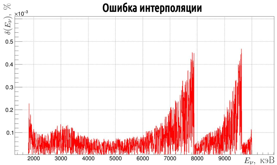
Рисунок 5.2 — Ошибка интерполяции спектра позитронов
