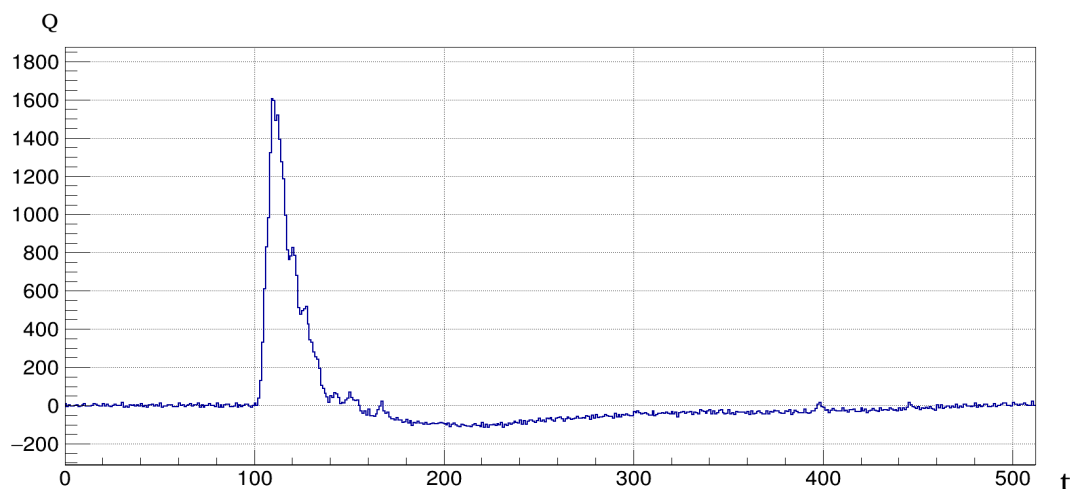
Рисунок 2.3 – Вид сигнала с детектора при попадании гамма-кванта в мишень.
