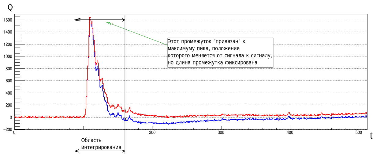
Рисунок 2.4 – Вид сигнала с детектора до деконволюции (синий) и после (красный) с указанием области интегрирования. Интегрирование производится по красному сигналу.
